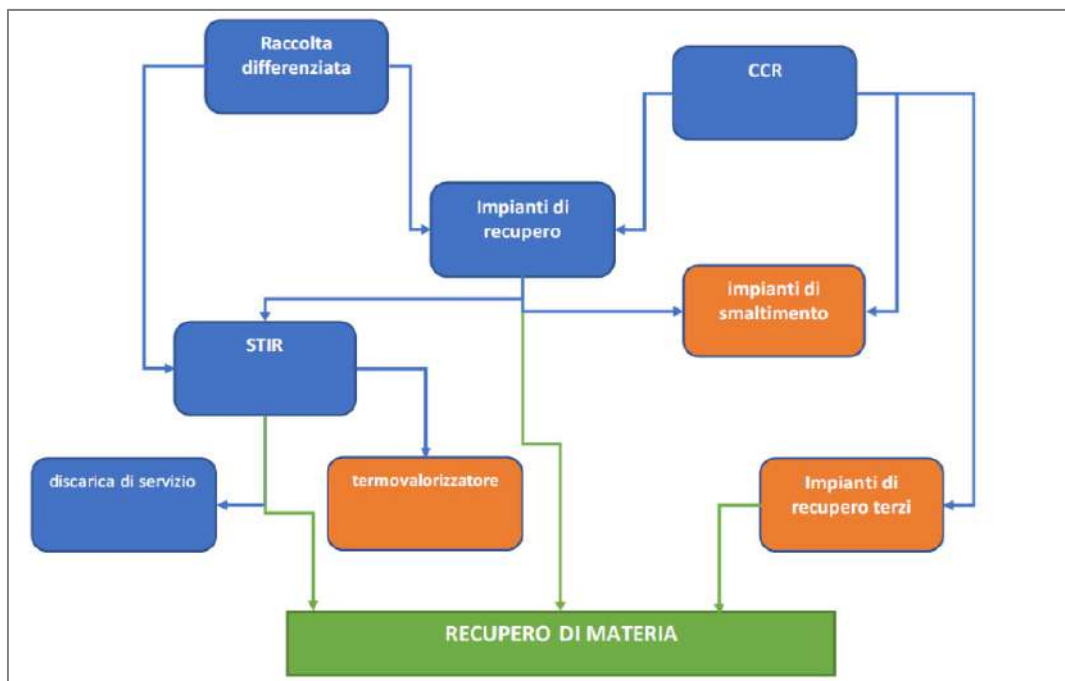
Figura 2.6 - Schema grafico rappresentativo del ciclo integrato che si intende attuare nel PdACE
